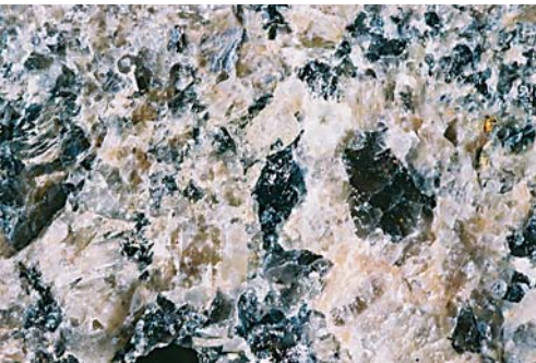
Alkuperäinen kivi on voimakkaasti migmatiittituumunut. Kuvan keskellä näkyy kordieriittirae. Näyte on Hiekkahentusen sora-kuopan loh-kare. Kordieriittirakeen läpimitta on noin 0,5 cm. Näytteen lahjoitti maxit Oy Ab .
